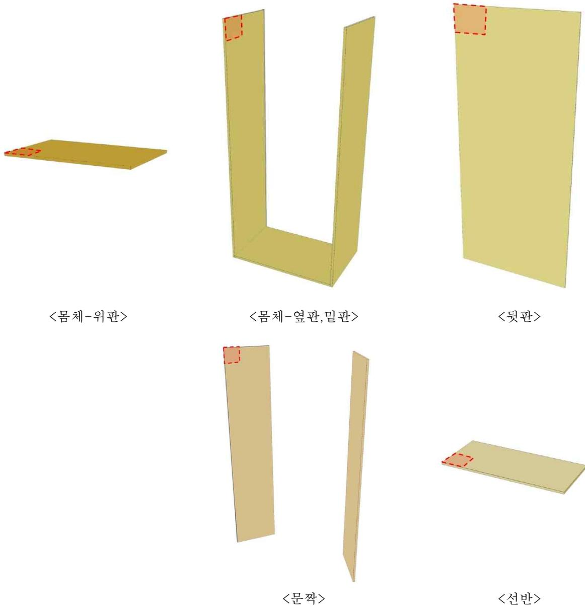
그림 3 - 가구용 구성재의 소형챔버용 시험편 채취 위치
