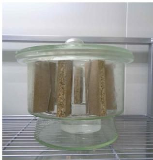
그림 12 - 데시케이터 내의 시험편 설치
