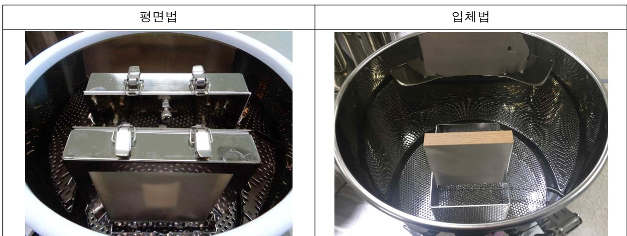
그림 8 - 시험편 설치의 예
